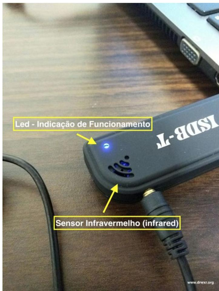
(Receptor Infravermelho do RTL-SDR)
